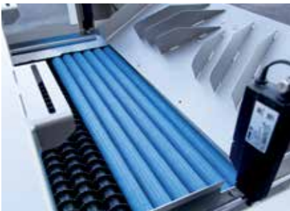
Vibrations- und Verteiltrichter Das Lesegut wird zu den Verteilrollen geleitet.
