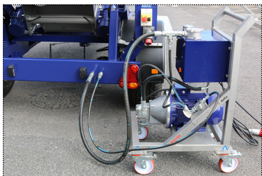
Centrale hydraulique indépendante
