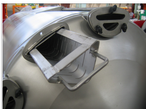
Ausbau der Saftkanäle
